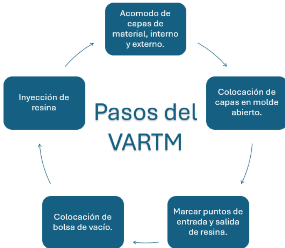
Figura 14. Diagrama del método de resina asistida por vacío.
