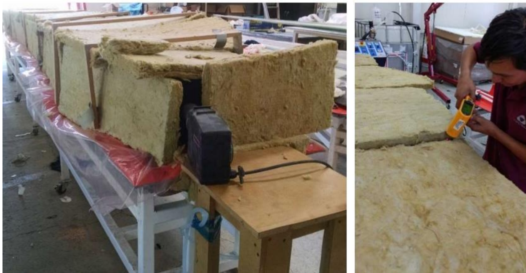
Figura 21. Encajonado usado para aspa de 6m lado succión del molde, CIATEQ A.C. (2020)
