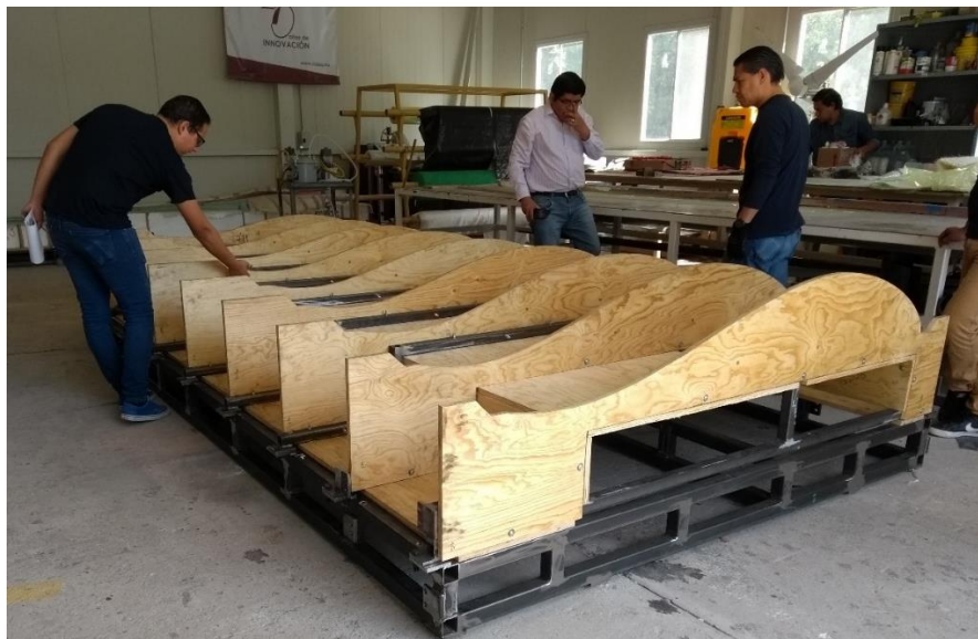
Figura 15. Molde maestro lado succión (CIATEQ A.C.).
