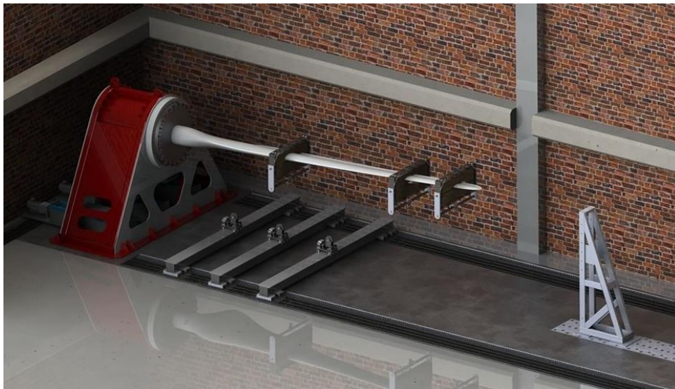
Figura 7. Prueba estructural estática, realizada en el Laboratorio de Innovación en Energía Eólica (CIATEQ A.C.).
