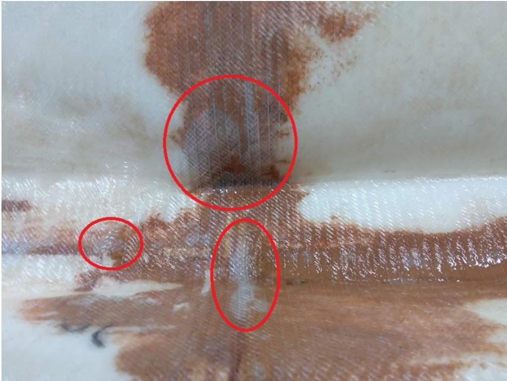
Figura 16. Burbujas visibles en la superficie entre el molde y la fibra de vidrio (CIATEQ A.C.).
