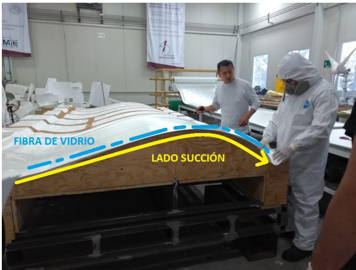
Figura 17. Acomodo de fibra, molde lado succión (CIATEQ A.C.).
