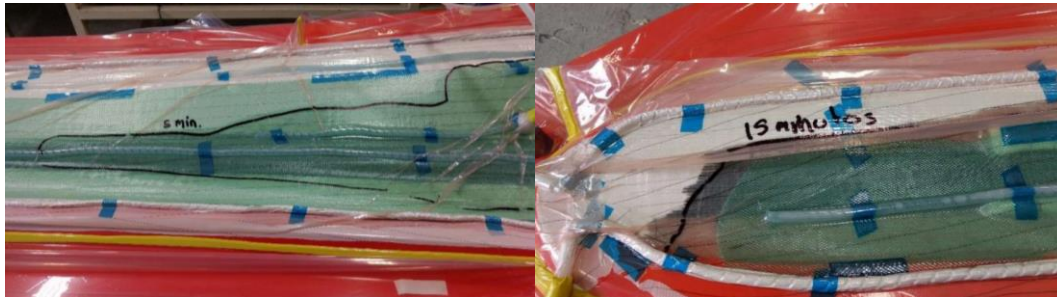
Figura 20. Frente de resina a los 5 y 15 minutos del inicio de la infusión, Zamudio (2020).
